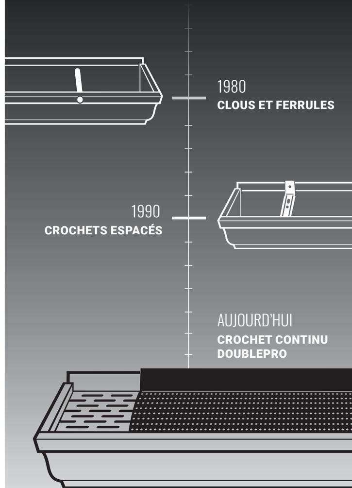
Le crochet continu est le seul système de fixation qui confère de la rigidité à la gouttière sur toute sa longueur. Il élimine les points faibles que d'autres systèmes génèrent entre les clous et les crochets espacés.
